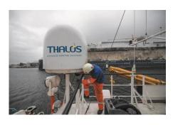
由THALOS开发和运营的OceanBox<sup>2</sup>连接解决方案管理着船舶所有传入和传出的连接资源。 作为所有联系的交换中心点 ・ 它优化了数据流并使卫星链接变得可靠。
